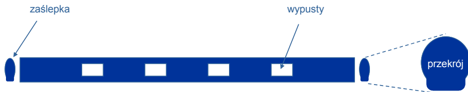
Rysunek 6. Diagram kształtu i przekroju rurki aluminiowej
