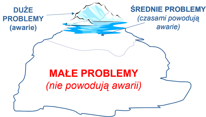
Rysunek 5. Odkrycie i usunięcie ukrytych usterek w Fazy 1 zapobiega przekształceniu się ich w średnie usterki a później w awarie
